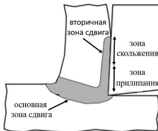
Рис. 5. Зоны сдвига и трения в процессе стружкообразования
