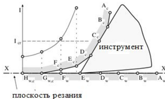
Рис. 3. Схема физического критерия стружкоотделения
