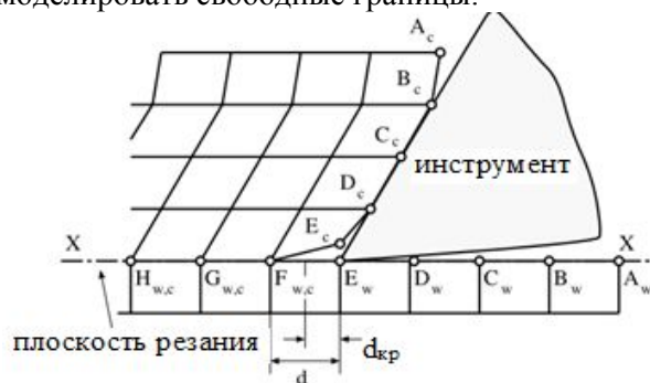
Рис. 2. Схема геометрического критерия стружкоотделения
